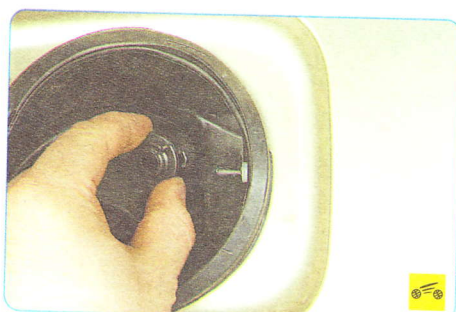
8. ...снимите запорное устройство люка наливной горловины.
