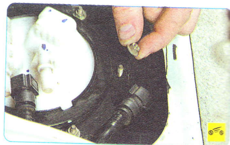
12. Отверните шесть гаек крепления прижимного кольца...
