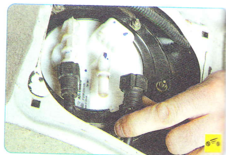
9. ...отсоедините от штуцера топливного модуля наконечник подающего топливопровода.
