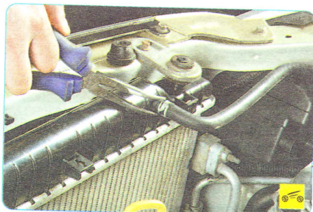
8. Ослабьте хомут крепления пароотводящего шланга к патрубку радиатора, сжав пассатижами его отогнутые ушки, сдвиньте хомут по шлангу...
