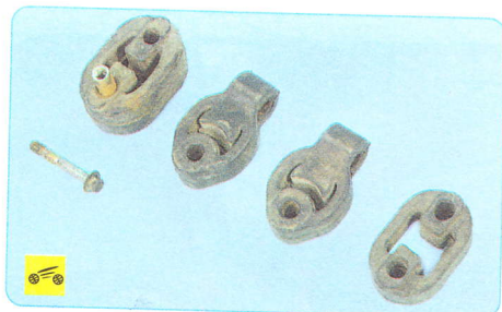
Элементы системы выпуска подвешены к кузову на четырех резиновых подушках.
