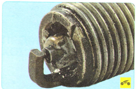
7. Изолятор свечи растрескавшийся или со сколами.
