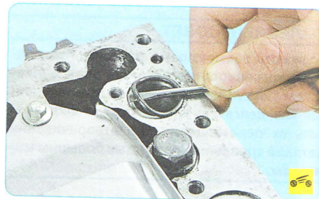
31. ...и установленное под ним уплотнительное кольцо.
