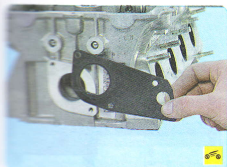
6. ...установленную под ним прокладку. 7. Снимите распределительные валы (см. «Снятие, диагностика и установка распределительных валов», с. 80).
