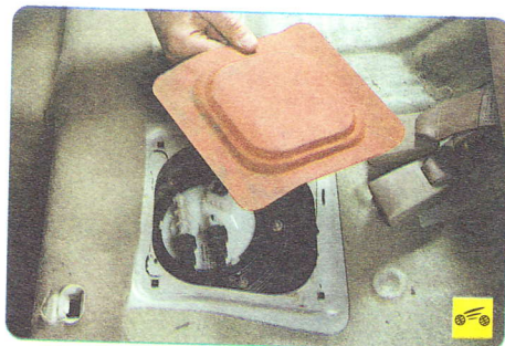
5. ...и снимите ее, отклеив от основания кузова.
