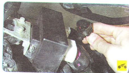
14. ...чтобы обе нижние опоры радиатора вышли из отверстий в кронштейнах кузова...
