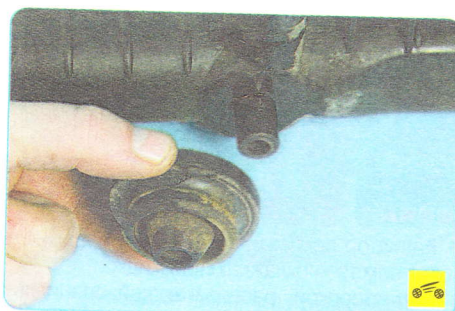
16. Снимите со штифтов бачков радиатора нижние резиновые подушки крепления радиатора.
