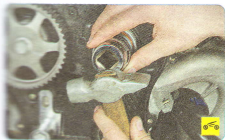
8. Установите сальник рабочей кромкой внутрь гнезда головки блока, аккуратно заправляйте рабочую кромку на распределительный вал (например, с помощью деревянной палочки) и запрессуйте до упора с помощью
