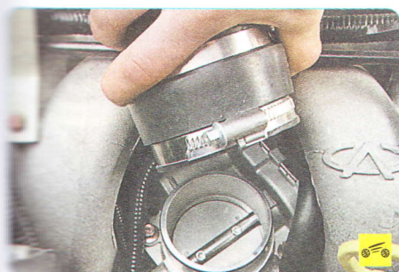
5. ...и отсоедините соединительный рукав от патрубка дроссельного узла.
