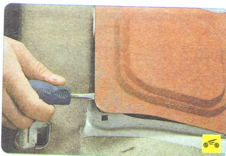
4. Подденьте отверткой крышку люка над топливным баком...
