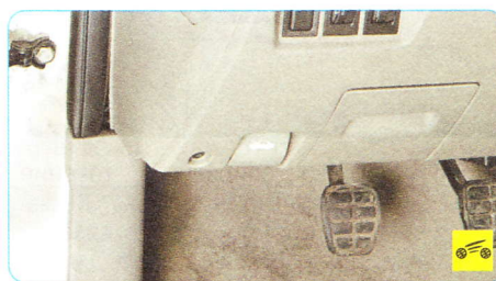
29 – рукоятка привода замка капота (см. «Капот», с. 34).
