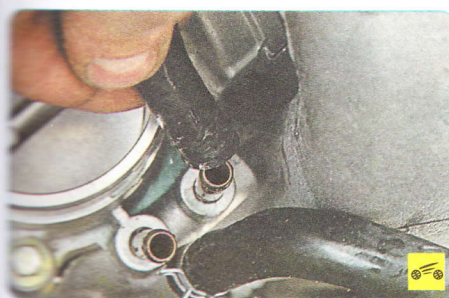
7. ...и снимите шланг с патрубка дроссельного узла.
